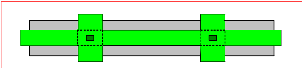
Figuur 11.4 – Overdrukkamer in dakopbouwen met lucht aanzuig via de dakranden
